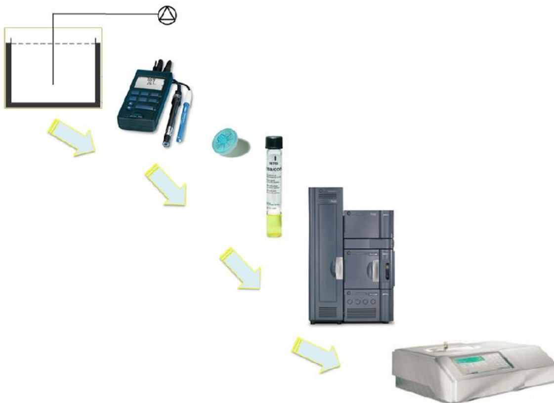
Slika 9. Dijagram toka eksperimentalnog dijela rada: shema reaktora za biorazgradnju, pH-metar, filter za injekcije (0,22 \mu\text{m} ), kiveta s reagensima za analizu KPK, UPLC, luminometar
