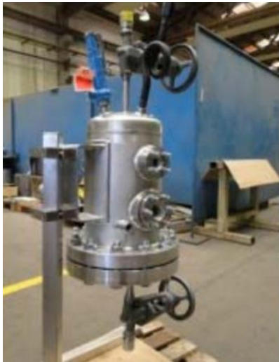
Slika 14. (a) Prototip visokotlačnog separatora za SSE tehnologiju konstruiran na Fakultetu za strojništvo, Sveučilišta u Ljubljani (Slovenija) u suradnji s tvrtkom „ECOM-Ruše“ iz Slovenije; (b) Separacijski proces u vertikalnom visokotlačnom separatoru; [14,15]
