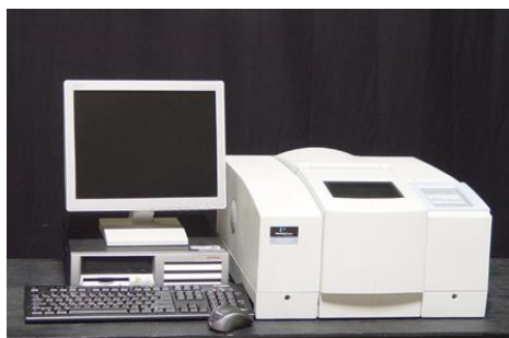
Slika 12. Perkin-Elmer Spectrum One FTIR spektrofotometar
