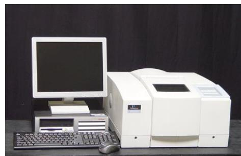
**Slika 12.** Perkin-Elmer Spectrum One FTIR spektrofotometar
