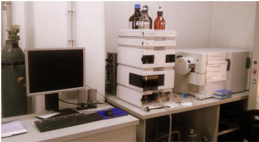
**Slika 28.** Agilent kromatografski sustav Series 1200 sa spektrometrom masa 6410 QqQ<sup>55</sup>
