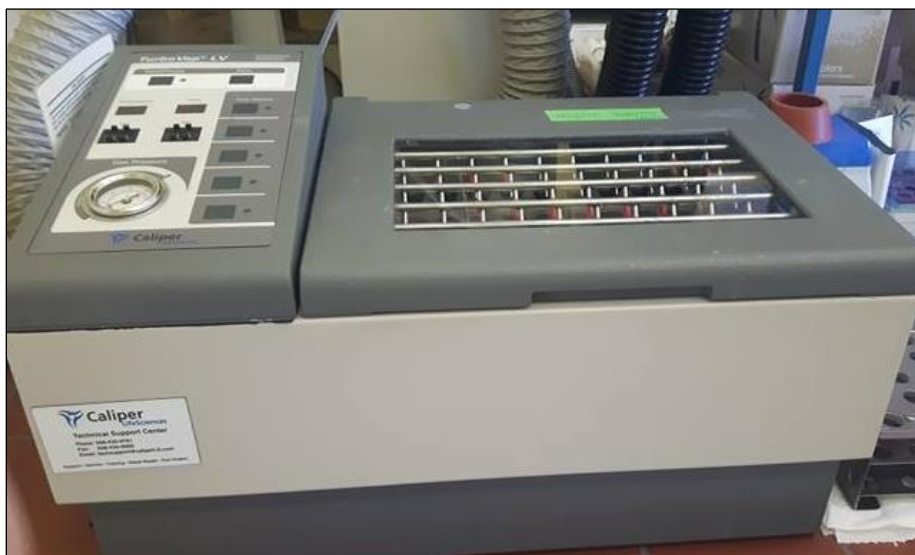
Slika 3.12. Uparivač, Caliper TurboVap LV.
