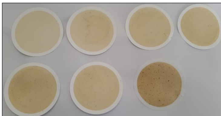
Slika 3.10. Izgled celulozno-nitratnih filtara nakon filtriranja uzorka rijeke Save.
