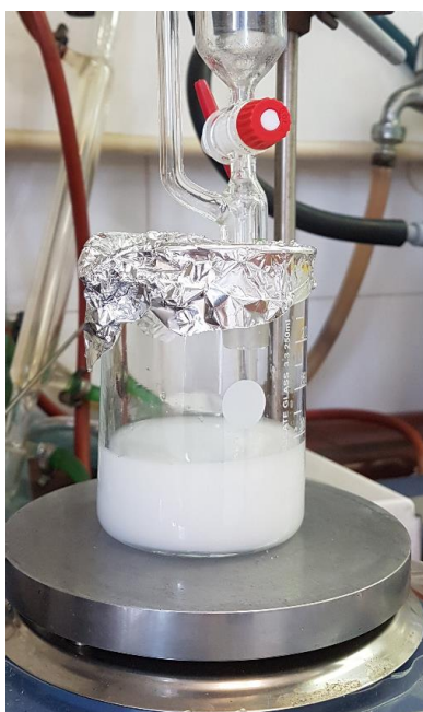
Slika 11. Priprema predemulzije uz dokapavanje monomera kroz lijevku
