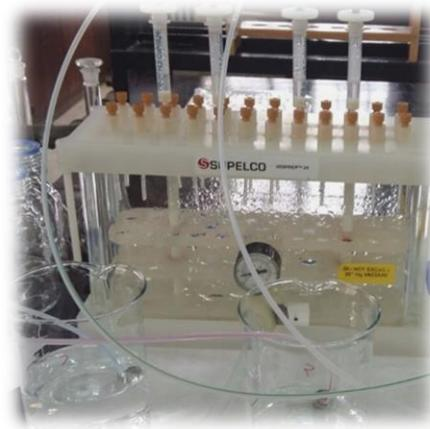
Slika 3.3. Supelco Visiprep 24 aparatura za SPE ekstrakciju
