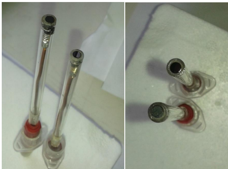
Slika 17. Prikaz GC elektrode prije i nakon oslojavanja polianilinom.
