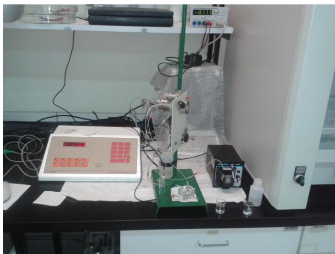
Slika 24. Aparaturaza izvedbu protočnog mjerenja pH.
