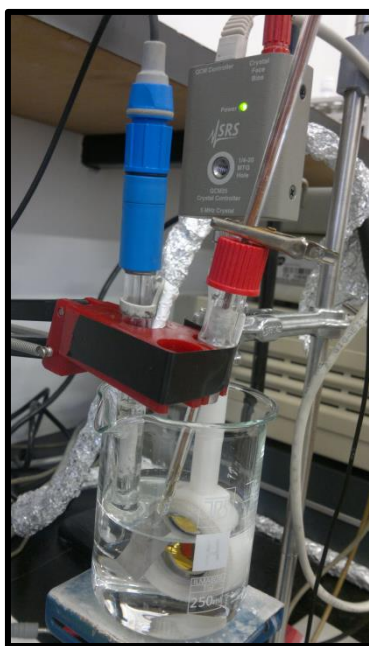
Slika 3.3. Troelektrodni sustav za elektrokemijsko ispitivanje GO-elektroda.
