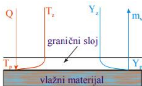
Slika 4. Prijenos tvari i topline u periodu konstantne brzine sušenja
