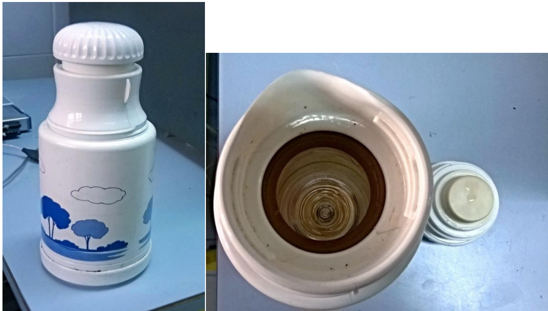
Slike 7: Adijabatski kotlasti reaktor 'termosica 200 ml'
