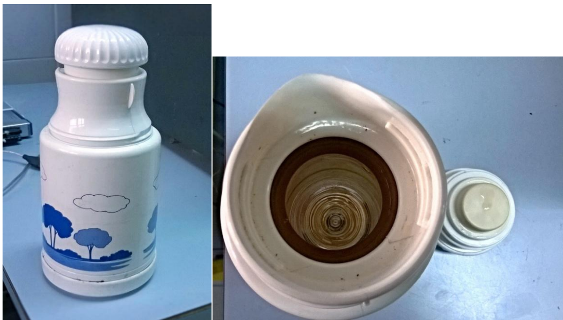
Slike 7: Adijabatski kotlasti reaktor 'termosica 200 ml'
