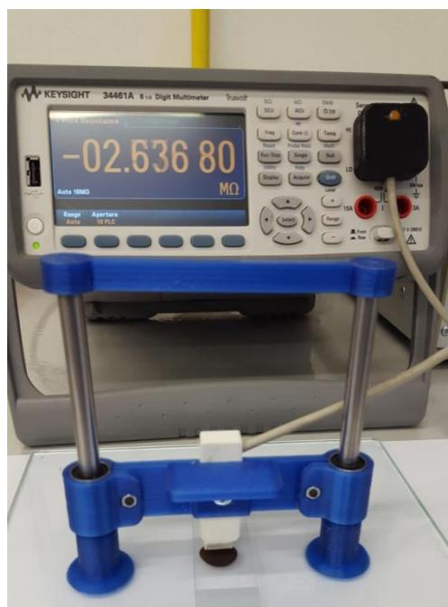
**Slika 3.13.** Uređaj i sonda za mjerenje električnog otpora
