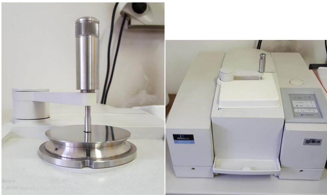
**Slika 3.16.** FT-IR spektrofotometar
