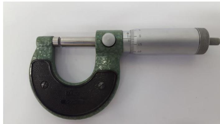
**Slika 3.15.** Uređaj za određivanje debljine listova
