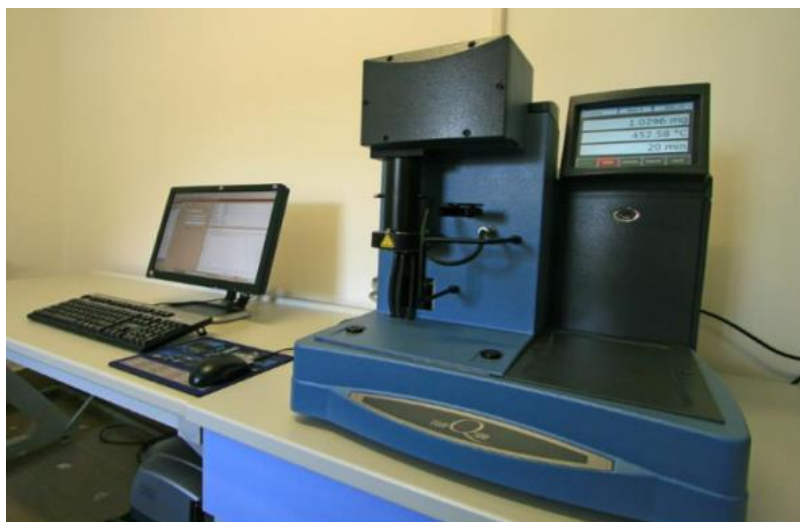
Slika 20. Termogravimetar, TA Instruments Q500
