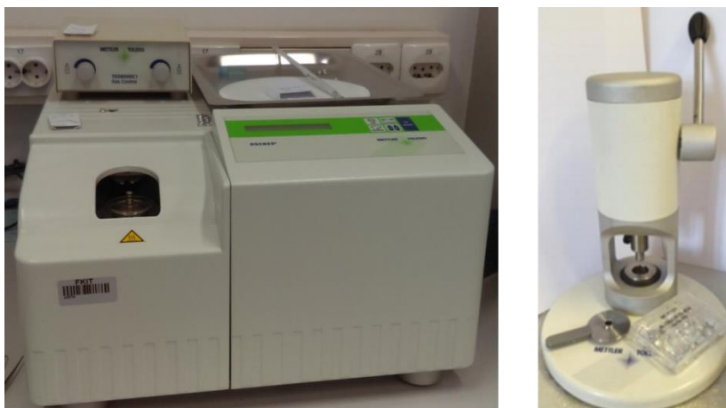
Slika 19. DSC (A) uređaj Mettler Toledo DSC 823e i (B) preša
