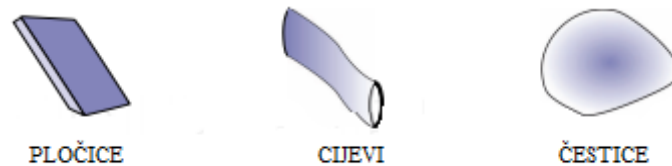
Slika 2. Vrste nanopunila s obzirom na strukturu 5
