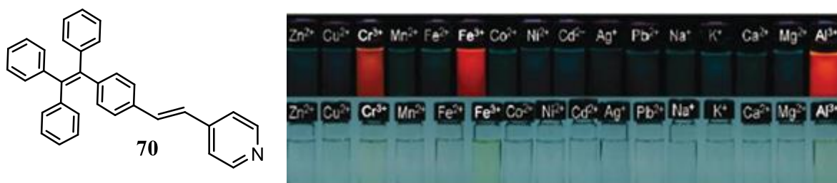
Slika 18. Spoj 70 koji služi kao senzor za trovalentne katione.
