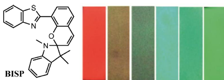
Slika 15. Struktura senzorske molekule (BISP), te promjena fluorescencije imobiliziranog BISP na TLC pločici u ovisnosti o koncentraciji pod UV svjetlom s valnom duljinom \lambda = 254 nm.
