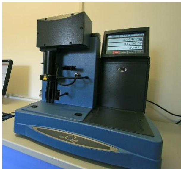
**Slika 3.4.** Termogravimetar Q500 TA Instruments
