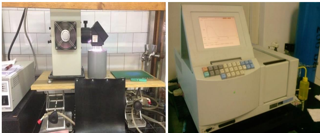
Slika 3.5. Simulator sunčevog zračenja, UV/Vis spektrometar Perkin Elmer Lambda EZ 201
