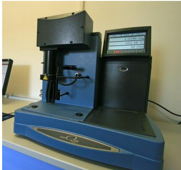
Slika 3.4. Termogravimetar Q500 TA Instruments
