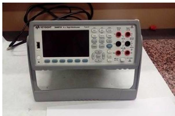
**Slika 3.3.** Uređaj za mjerenje električnog otpora *Keysight 34461 6<sub>1/2</sub> Digit Multimeter*
