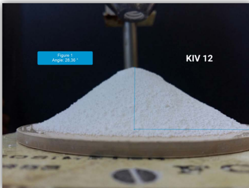
Slika 4.6. Fotografija formiranog stošca za granulat dobiven eksperimentom TS ; primjena KLONK Image Measurement softverskog paketa u određivanju kuta mirovanja.
