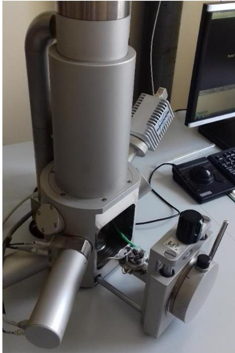
**Slika 23.** Pretražni elektronski mikroskop VEGA 3 SEM.
