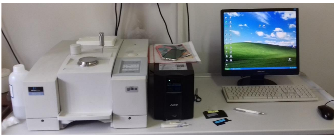
Slika 19. FTIR spektrofotometar Perkin-Elmer Spectrum.
