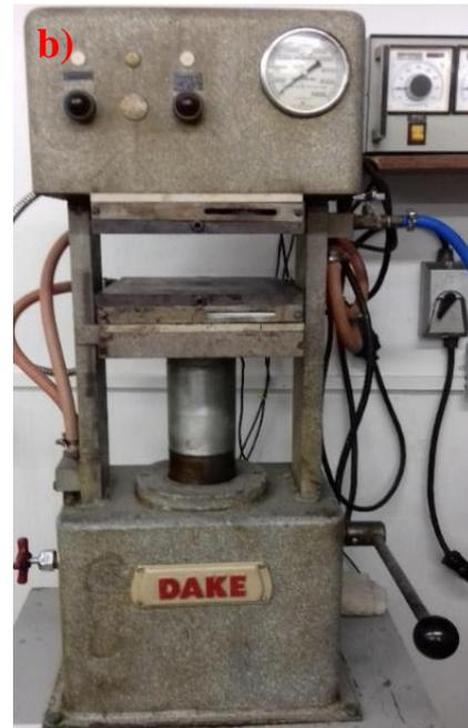
*Slika 18.* Hidrauličke preše: Fontune (a); Dake (b).
