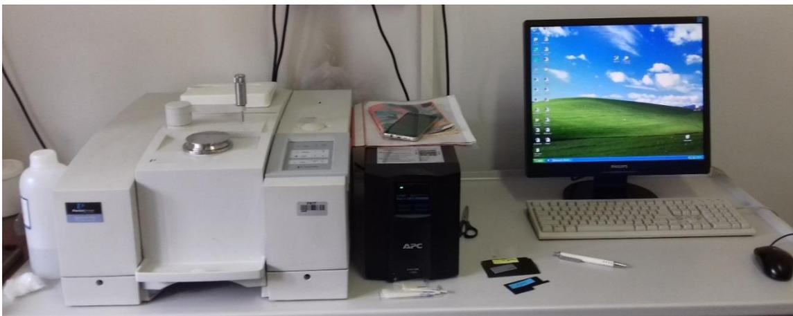
**Slika 19.** FTIR spektrofotometar Perkin-Elmer Spectrum.
