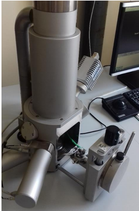
Slika 23. Pretražni elektronski mikroskop VEGA 3 SEM.
