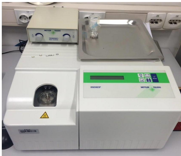
Slika 22. Razlikovni pretražni kalorimetar Mettler Toledo DSC 823e.
