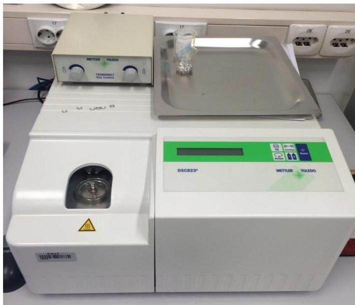
*Slika 22.* Razlikovni pretražni kalorimetar Mettler Toledo DSC 823e.
