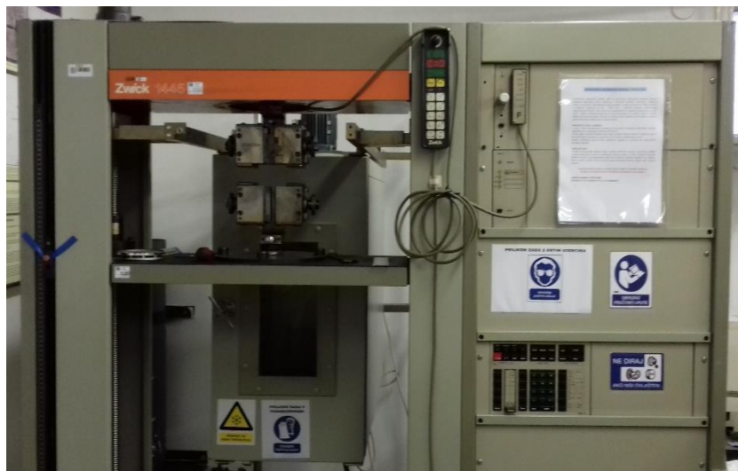
Slika 21. Mehanička kidalica Zwick 1445.
