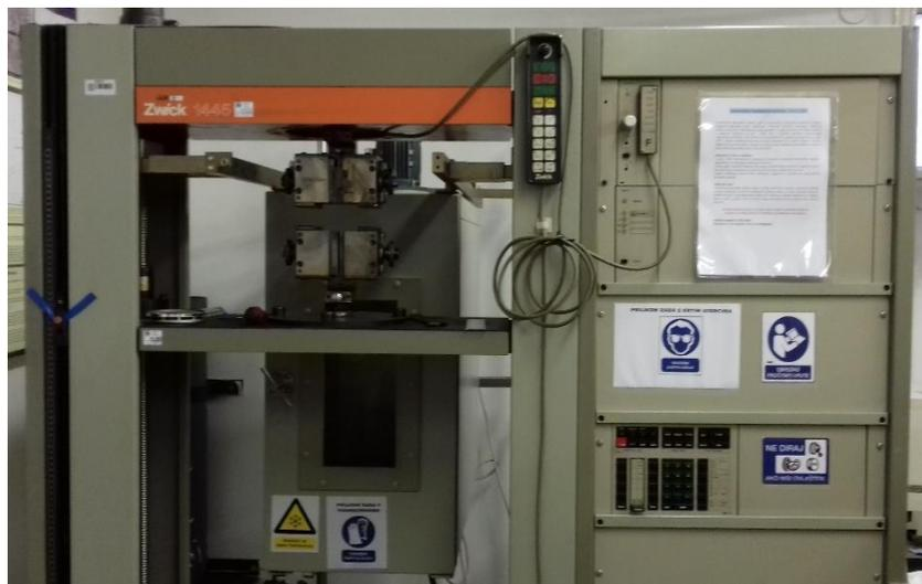
*Slika 21.* Mehanička kidalica Zwick 1445.
