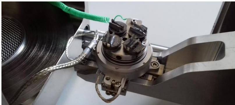
**Slika 24.** Uzorci napareni zlatom u komori mikroskopa.
