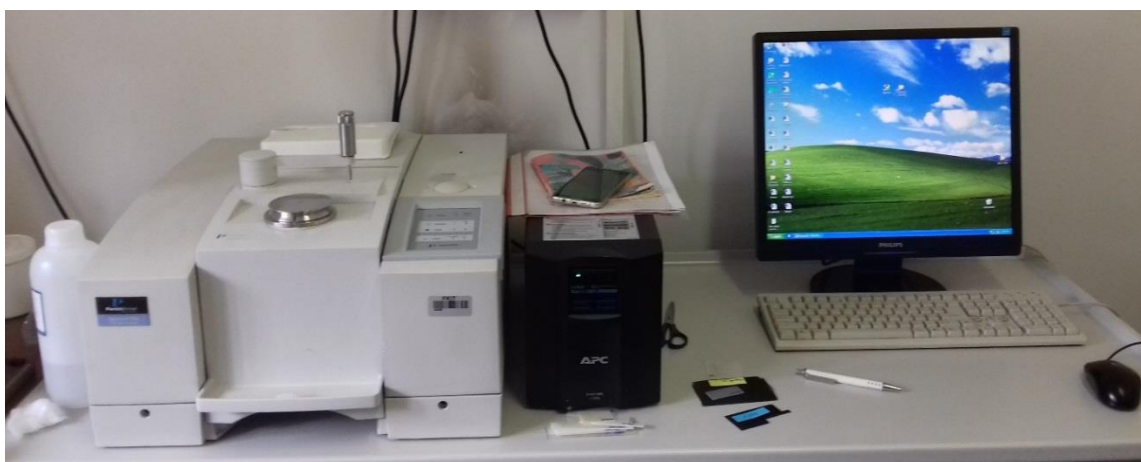
Slika 19. FTIR spektrofotometar Perkin-Elmer Spectrum.
