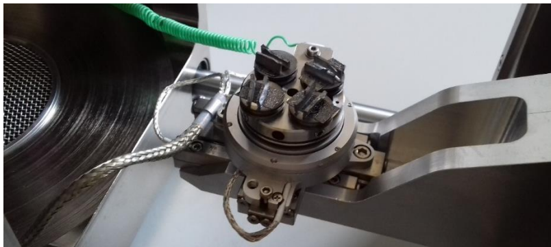
Slika 24. Uzorci napareni zlatom u komori mikroskopa.
