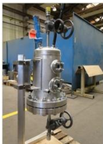
Prototip visokotlačnog separatora - »Ecom« Ruše, Slovenija.
