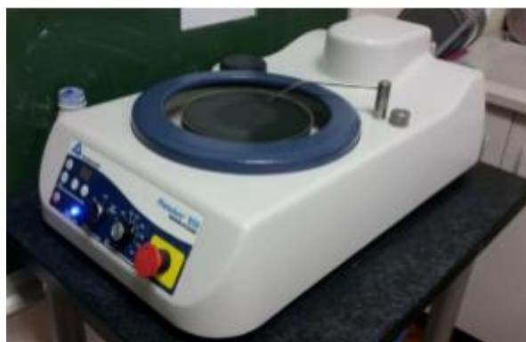
**Slika 3.1.** Uređaj za poliranje
