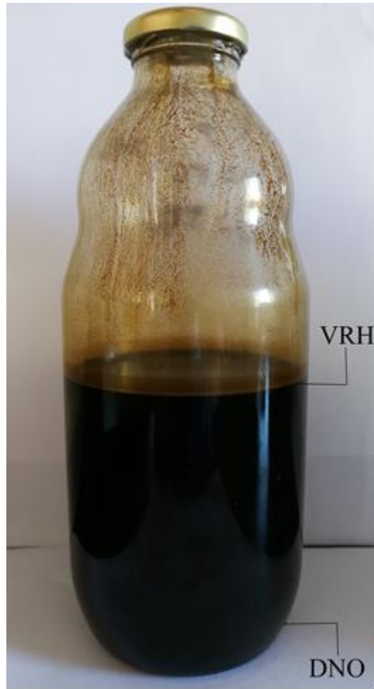
Slika 3.4. Prikaz mjesta uzorkovanja vrha i dna u boci.
