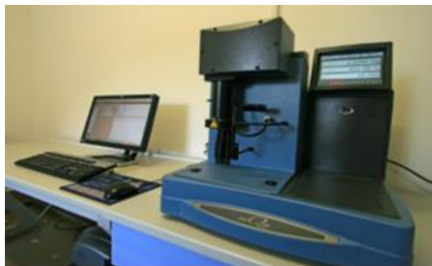
Slika 3.10. Uređaj korišten za provođenje termogravimetrijske analize.
