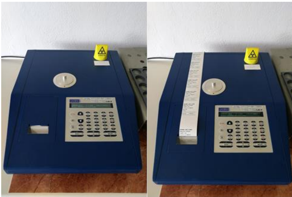
Slika 3.7. Analizator OXFORD EDXRF LAB X – 3500 prije i nakon završetka mjerenja.
