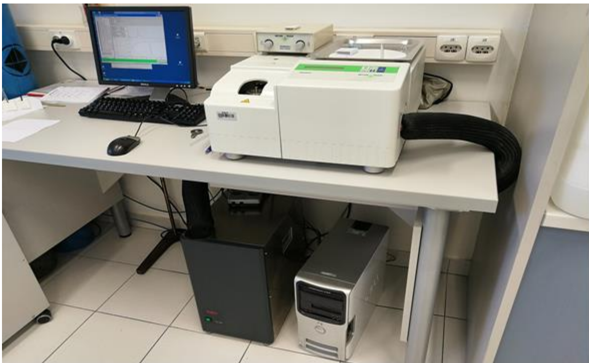
Slika 3.11. Diferencijalni pretražni kalorimetar Mettler Toledo s računalom.
