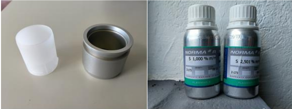
Slika 3.8. Testna posudica, metalno kučište i SUS uzorci za kalibraciju.
