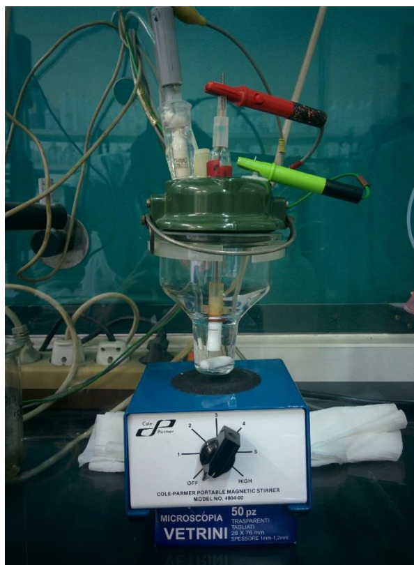
Slika 10. Troelektrodni elektrokemijski sustav za mjerenje.
