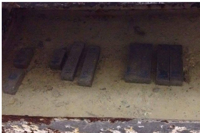
Slika 17. Kada za odležavanje prizmi pod vodom
