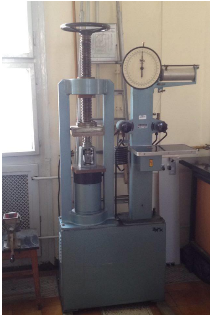
Slika 18. Hidraulična preša za određivanje čvrstoće na tlak
