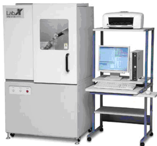
Slika 5. Rendgenski difraktometar Shimadzu XRD 6000.
