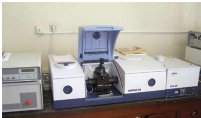
Slika 6. Infracrveni spektrometar s Fourierovom transformacijom signala (FTIR) Bruker Vertex 70.
