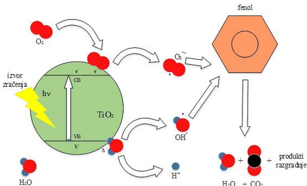
**Slika 2.2.** Mehanizam heterogene fokatalize
