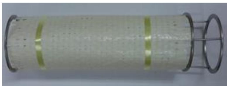
**Slika 3.4.** Katalizator na nosaču
