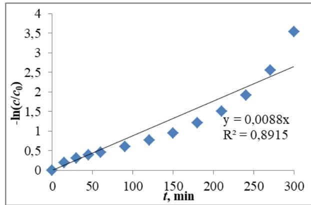
**Slika 7.10.** Kinetička krivulja pseudo-prvog reda za reakciju fotokatalitičke razgradnje fenola pri 365 nm (suspendirani sloj,  $m_{\text{TiO}_2} = 0,4 \text{ g}$ ,  $c_{\text{F}0} = 25 \text{ mg/L}$ ,  $T = 40 \text{ }^{\circ}\text{C}$ ,  $Q_{\text{R}} = 300 \text{ mL/min}$ )
