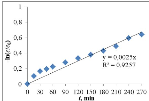
**Slika 7.8.** Kinetička krivulja pseudo-prvog reda za reakciju fotokatalitičke razgradnje fenola pri 365 nm (suspendirani sloj,  $m_{\text{TiO}_2} = 0,4 \text{ g}$ ,  $c_{F0} = 50 \text{ mg/L}$ ,  $T = 30 \text{ }^\circ\text{C}$ ,  $Q_R = 300 \text{ mL/min}$ )
