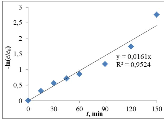
**Slika 7.6.** Kinetička krivulja pseudo-prvog reda za reakciju fotokatalitičke razgradnje fenola pri 365 nm (suspendirani sloj,  $m_{\text{TiO}_2} = 0,4 \text{ g}$ ,  $c_{F0} = 12,5 \text{ mg/L}$ ,  $T = 30 \text{ }^\circ\text{C}$ ,  $Q_R = 300 \text{ mL/min}$ )
