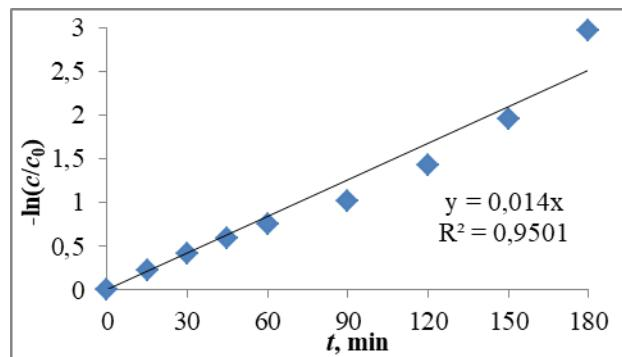
**Slika 7.12.** Kinetička krivulja pseudo-prvog reda za reakciju fotokatalitičke razgradnje fenola pri 365 nm (suspendirani sloj,  $m_{\text{TiO}_2} = 2 \text{ g}$ ,  $c_{\text{F}0} = 12,5 \text{ mg/L}$ ,  $T = 30 \text{ }^{\circ}\text{C}$ ,
