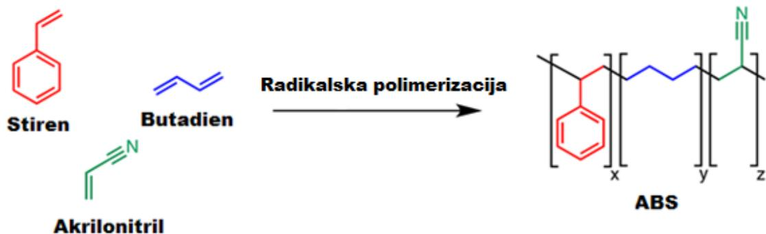
Slika 3 Shematski prikaz molekule ABS-a [10]
