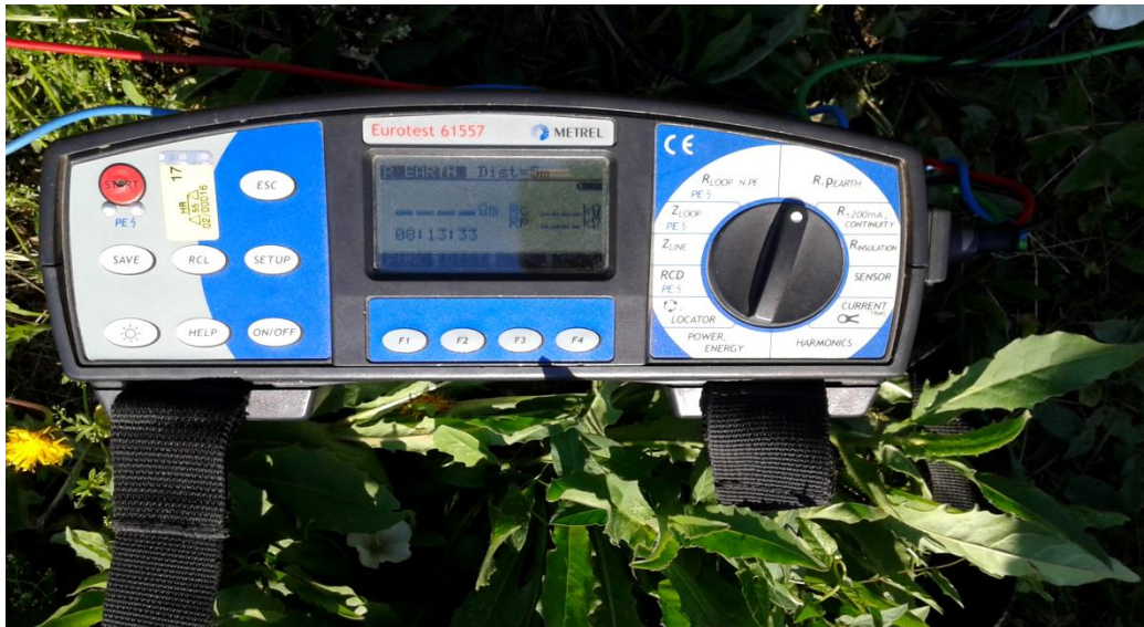
Slika 32. Mjerni uređaj Eurotest - Metrel 61557
