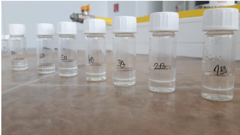
Slika 3.5. Pripravljene nestabilne otopine za sustav butil acetat – propionska kiselina – voda u bočicama od 10 ml, nakon raslojavanja.
