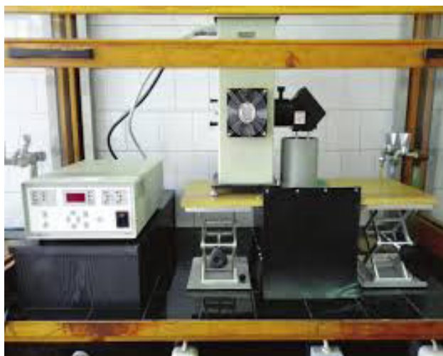
Slika 9. Simulator Sunčevog zračenja.
