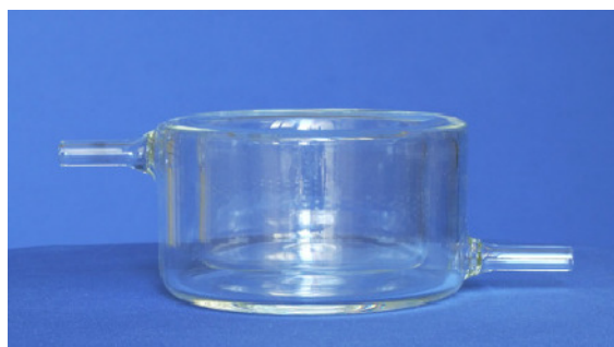
Slika 8. Kotlasti reaktor sa vodenim hlađenjem
