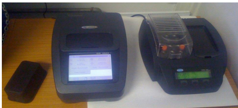
Slika 12. DR 2800 spektrofotometar, Hach Lange (s prijenosnim termoblokom).
