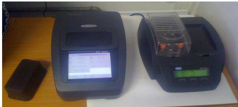
**Slika 12.** DR 2800 spektrofotometar, Hach Lange (s prijenosnim termoblokom).
