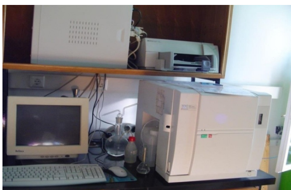
Slika 11. TOC analizator, TOC-VCPN, Shimadzu.
