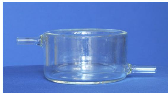
**Slika 8.** Kotlasti reaktor sa vodenim hlađenjem
