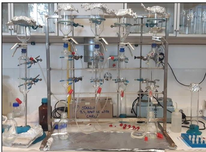
Slika 15. Postolje i aparatura za postupak provedbe filtracije.
