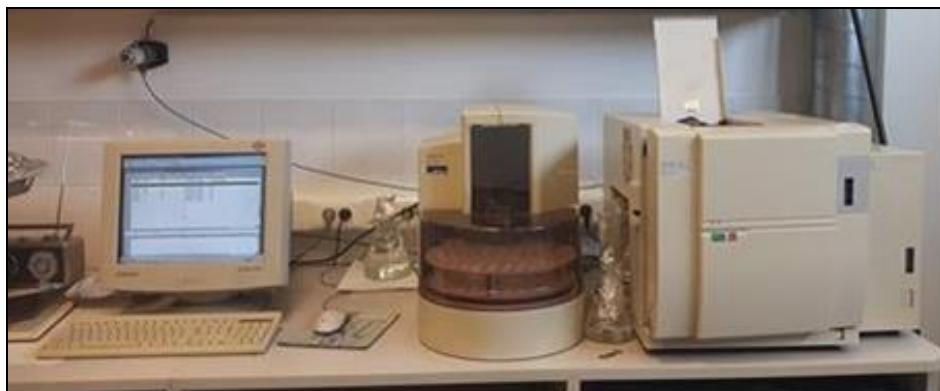
Slika 9. TOC analizator, Shimadzu TOC-V<sub>CPH</sub> + ASI-V autosampler.
