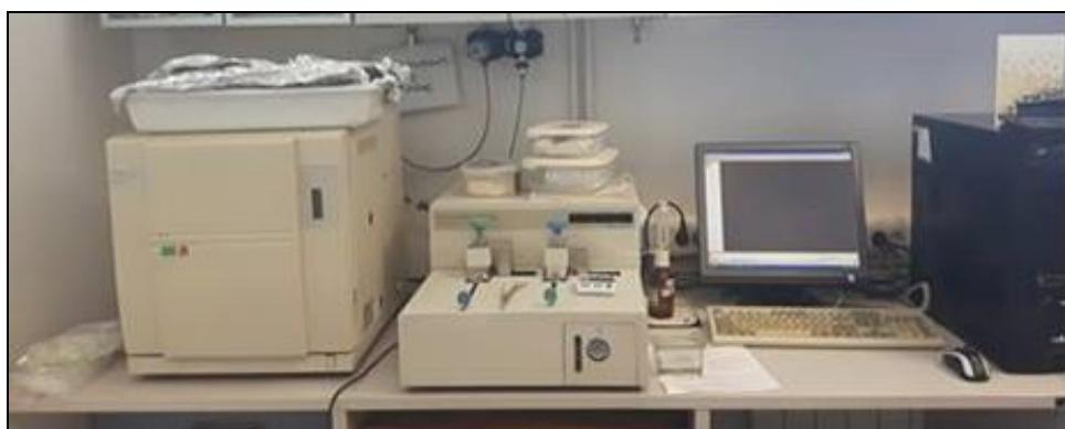
Slika 10. TOC analizator, Shimadzu TOC-V<sub>CPH</sub> + SSSM-5000A.
