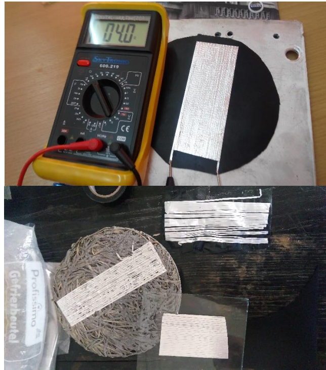
Slika 3.2.3. Aluminijska traka kao grijač u više izvedbi v
