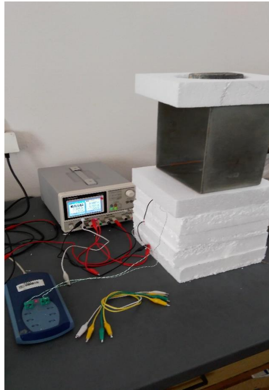
Slika 3.2.4 Izrada izolacijskog spremnika za aparaturu v
