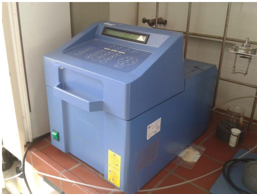
Slika 3.2.6. Uređaj IKA ® Calorimeter System C 7000 sa hladilom Cooler C 7002.
