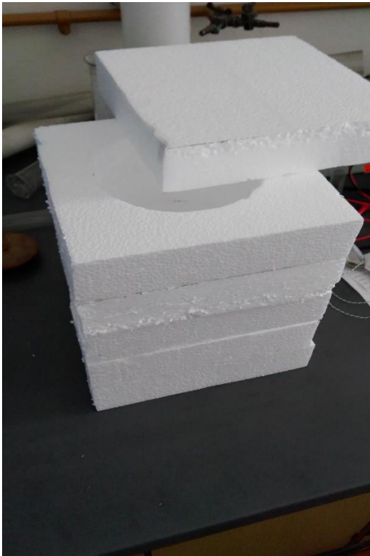
Slika 3.2.4 Izrada izolacijskog spremnika za aparaturu v
