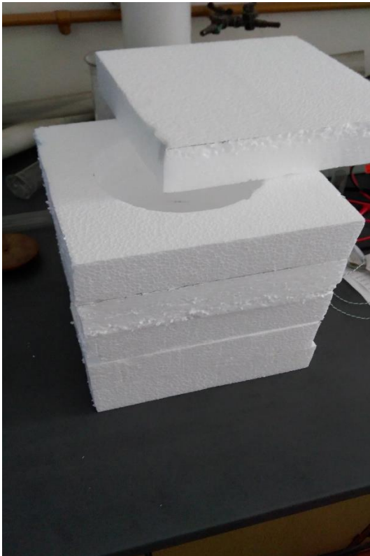
Slika 3.2.4 Izrada izolacijskog spremnika za aparaturu v
