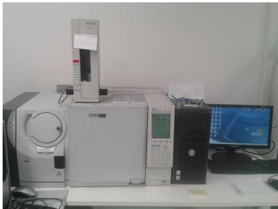
Slika 6. Vezni sustav plinski kromatograf-spektrometar masa GCMS-QP2010 Plus,
