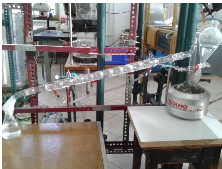
Slika 7. Aparatura za provedbu hidrodestilacije u studenom 2016. godine
