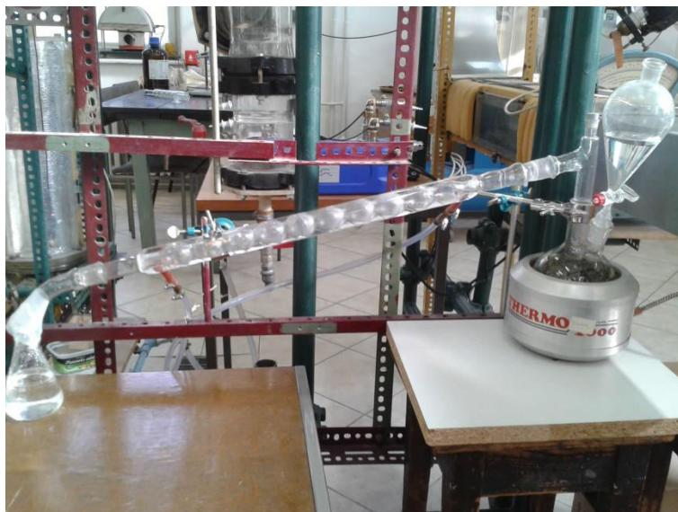
Slika 7. Aparatura za provedbu hidrodestilacije u studenom 2016. godine
