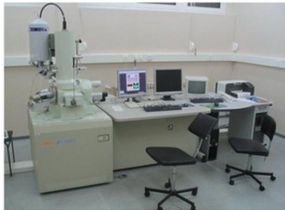
*Slika 3.2.* Visokorezolucijski pretražni elektronski mikroskop
