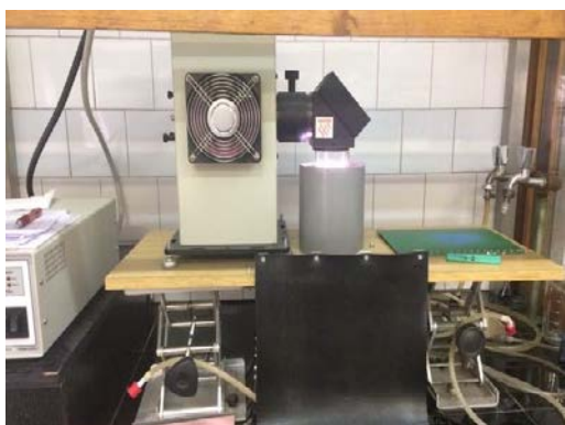
Slika 3.5. a) Simulator Sunčevog zračenja, b) UV/Vis spektrometar Perkin Elmer Lambda EZ 201
