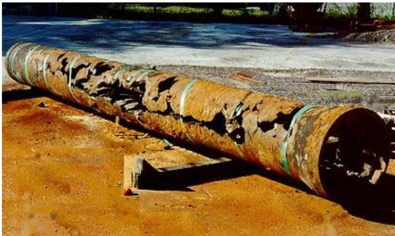
**Slika 2.17.** Utjecaj korozije na nezaštićenu cijev
