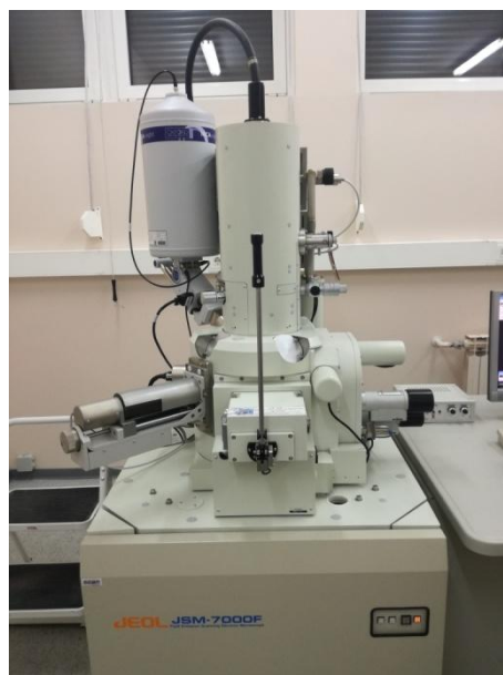
Slika 14. Pretražni elektronski mikroskop Joel JSM-7000F
