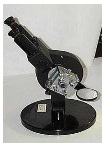
**Slika 3.7. Abbeov refraktometar**
