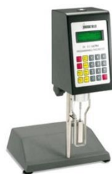
Slika 3.5. Rotacijski reometar Brookfield DV - III ULTRA
