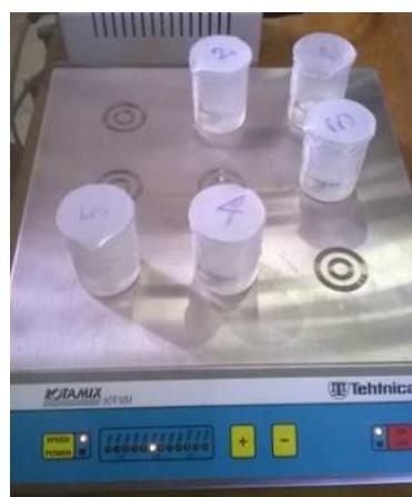
**Slika 3.3.** Magnetska mješalica *ROTAMIX 609 M*
