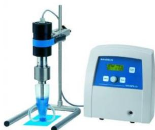
Slika 3.2. Ultrazvučni homogenizator *Bandelin sonoplus HD 3200*
