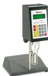
**Slika 3.5.** Rotacijski reometar *Brookfield DV - III ULTRA*
