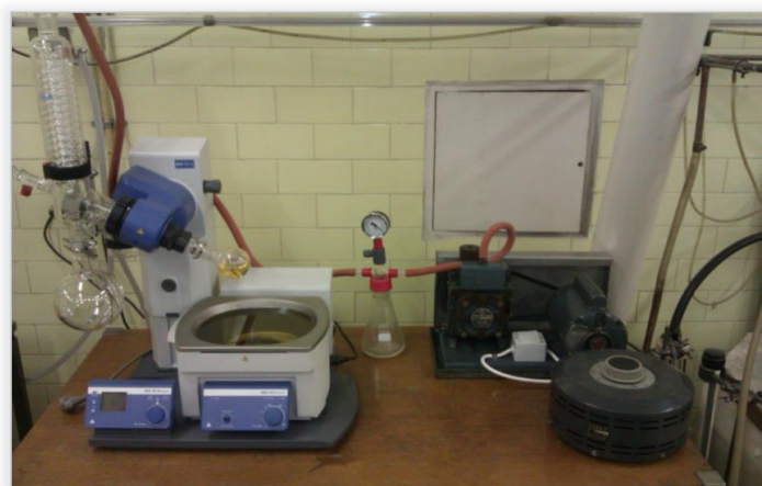
Slika 3.1. Rotacijski vakuum isparivač IKA RV 10, Basic
