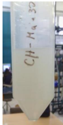
Slika 4.7. Stanje nanosuspenzije CH:MA:30 + Al 2 O 3 nakon 7 dana
