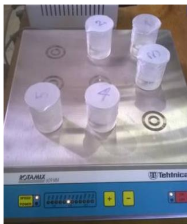
Slika 3.3. Magnetska mješalica ROTAMIX 609 M
