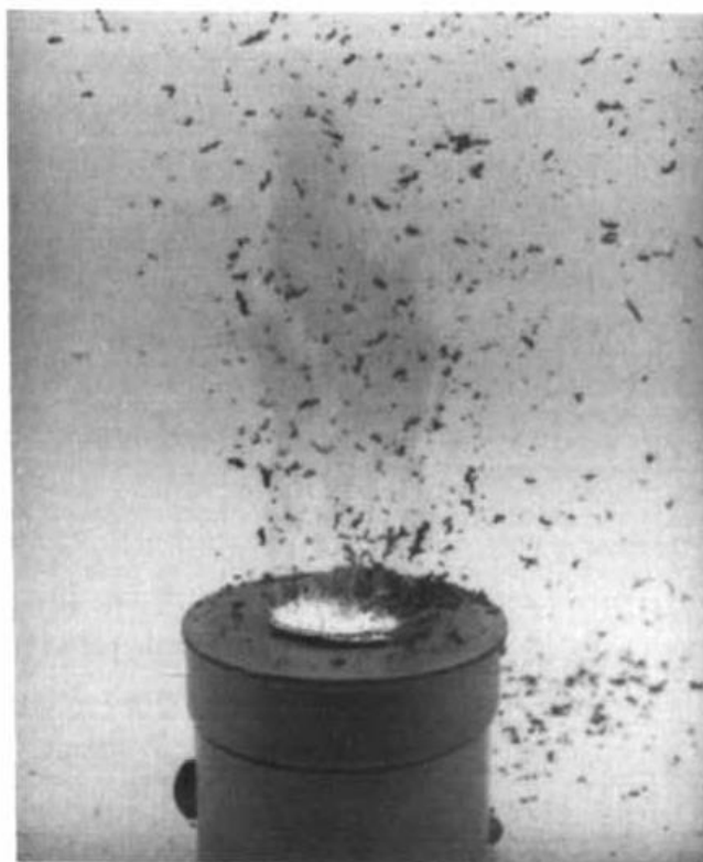
Slika 6. Eksplozivno izgaranje u Pechinijevoj metodi 22
