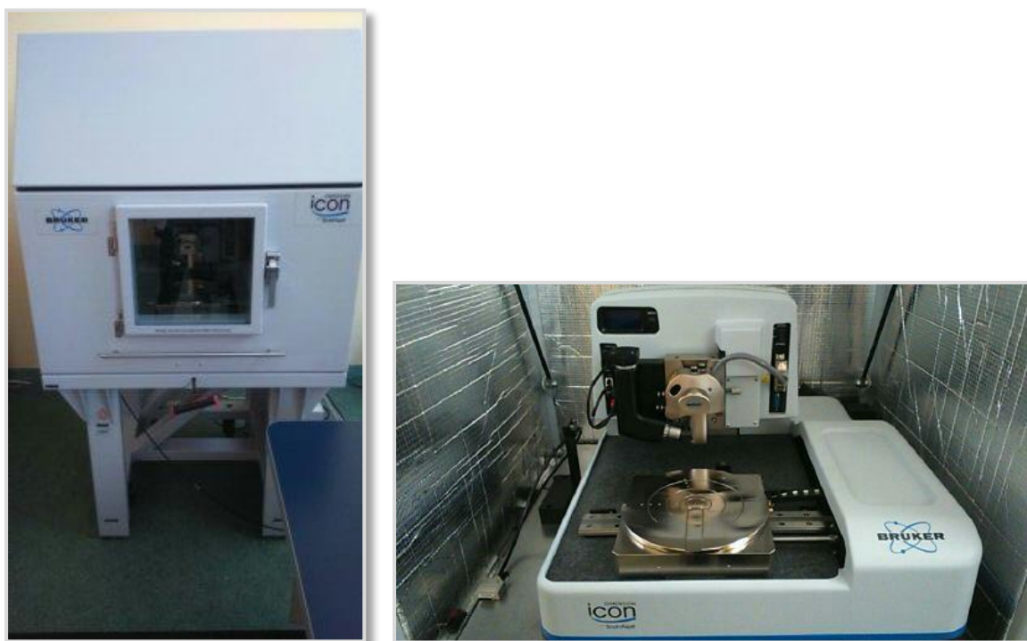
Slika 12. AFM uređaj NanoScope Analysis programme 1.40 BRUKER
