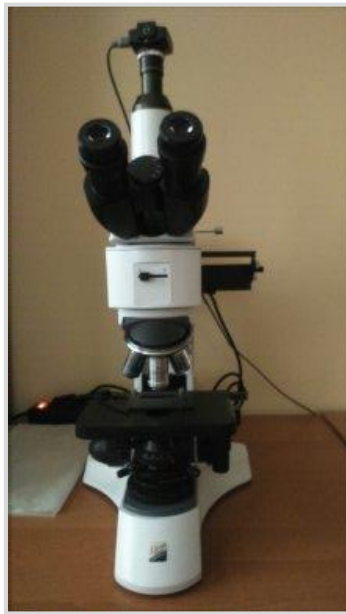
Slika 11. Optički mikroskop - MMT 800 BT metallographic microscope, Mikrolab, Poland
