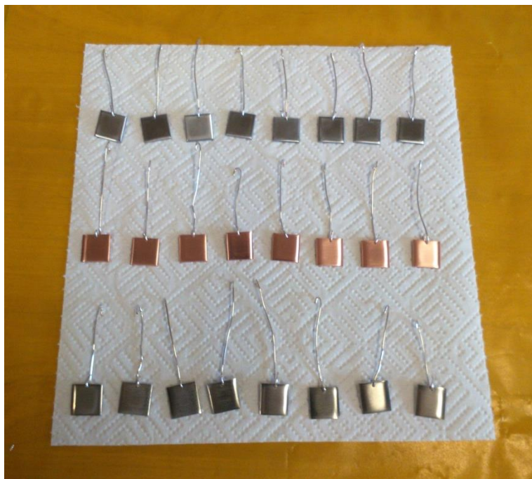
Slika 8. Pločice čelika, bakra i aluminija nakon brušenja i poliranja
