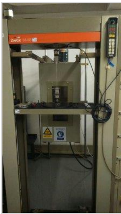
Slika 13. Uređaj za mjerenje čvrstoće, Zwick 1445
