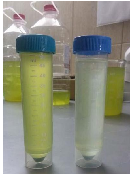
Slika 21. Uzorak algi prije i poslije centrifugiranja
