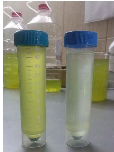
Slika 21. Uzorak algi prije i poslije centrifugiranja
