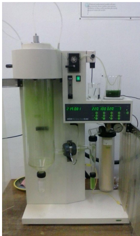
Slika 24. Sušionik s raspršivanjem Buchi Mini spray dryer B-290
