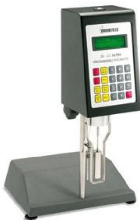
Slika 27: Rotacijski viskozimetar Brookfield DV – III ULTRA
