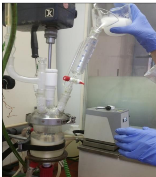
Slika 16. Aparatura korištena za provedbu emulzijske polimerizacije
