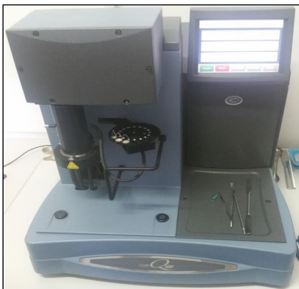
Slika 21. TGA uređaj tvrtke TA Instruments
