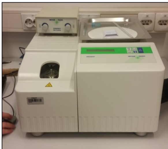
Slika 19. Diferencijalni pretražni kalorimetar Mettler toledo DSC 823 e
