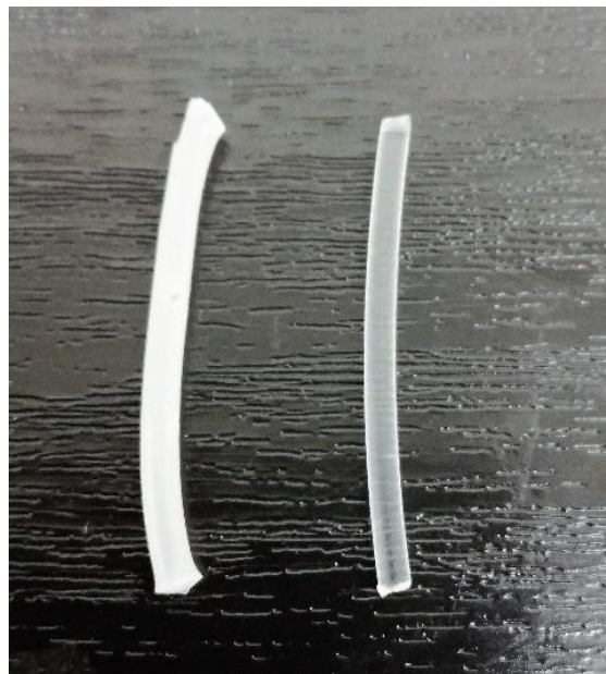
Slika 39. Ispitivani komad ABS-T filamenta nakon 6 sati izloženosti metanolu (lijevo) s vidljivim gubitkom transparentnosti u usporedbi s neizloženim filamentom (desno)
