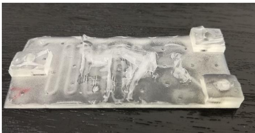
Slika 27. Mikroreaktor izrađen u vodoravnom položaju; vidljiva je zaostala očvrsnuta smola na strani koja je bila okrenuta prema gore, odnosno okrenuta prema podlozi, tijekom izrade
