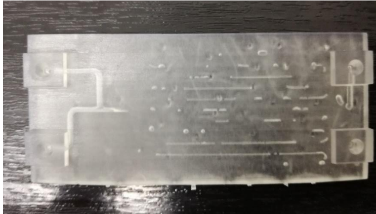
Slika 29. Mikroreaktor dobiven stereolitografijom; djelomično isprani kanali kvadratnog poprečnog presjeka širine 1100 \mu\text{m}
