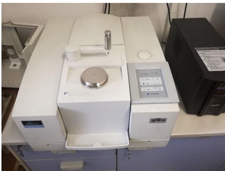
Slika 21. Infracrveni spektrofotometar s Fourierovom transformacijom signala PerkinElmer Spectrum One opremljen s ATR dodatkom
