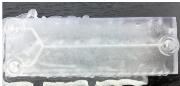
Slika 30. Mikroreaktor sa zatvorenim kanalima dimenzije 900 \mu\text{m} x 900 \mu\text{m} duljine 3,5 cm
