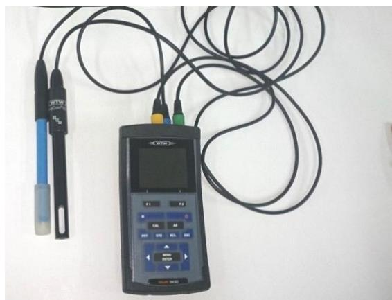
**Slika 3.4.** Uređaj za mjerjenje pH-vrijednosti i vodljivosti Multi 340i WTW.
