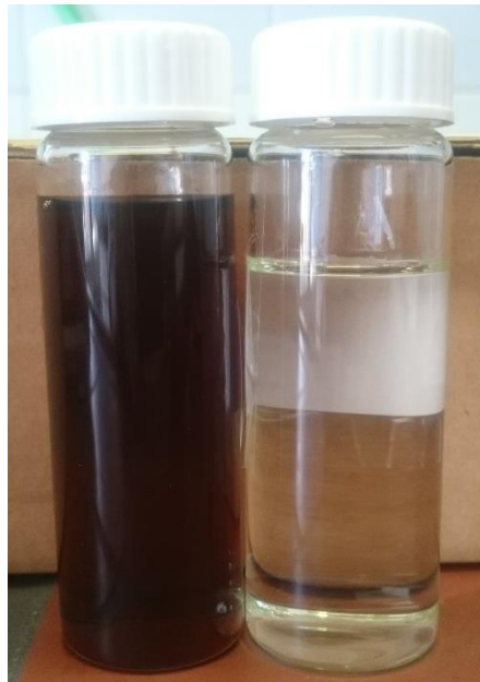
Slika 4.6.1. Uzorak naftalana (lijevo) i naftalana nakon adsorpcije, A1 (desno).
