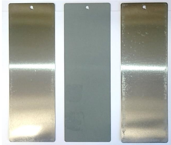
Slika 17. Uzorci ispitivani u slanoj komori
