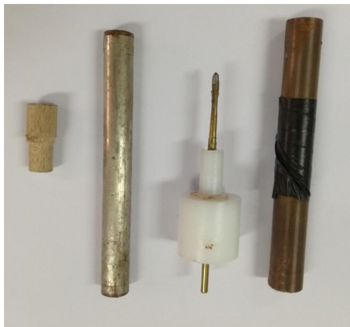
Slika 11. Fotografija prikazuje: a) izolacijski čep, b) bakreni kalup promjera 1cm, c) izolacijski čep s bakrenim umetkom za termopar, d) bakreni kalup promjera 2cm.
