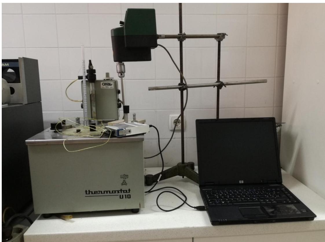
Slika 10. Fotografija korištenog sustava za mjerenje temperature u centru kalupa. Sustav se sastoji od temostata (prikazan uljni temostat), termopara i osobnog računala.
