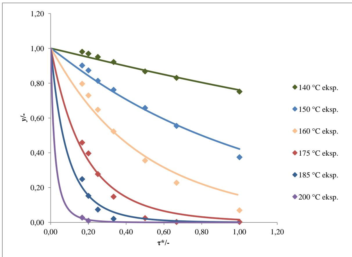
**Slika 23.** Usporedba eksperimentalnih rezultata (točke) s vrijednostima dobivenim prema modelu s međufaznom difuzijom (linije) za različite temperature monolitnog reaktora s  $\text{MnCuO}_x$  ( $m=0,0024 \text{ g}$ ).
