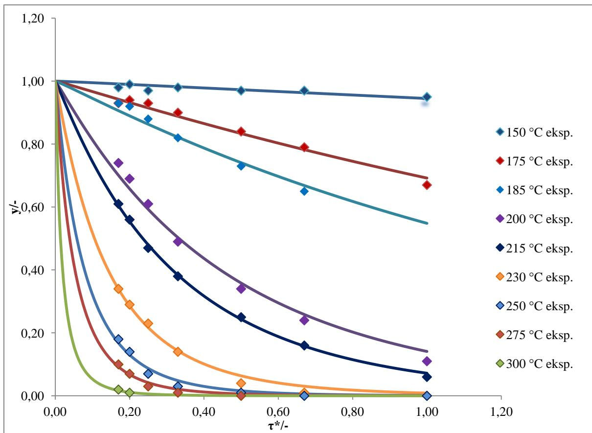
**Slika 21.** Usporedba eksperimentalnih rezultata (točke) s vrijednostima dobivenim prema modelu koji uključuje međufaznu difuziju (linije) pri različitim temperaturama u monolitnom reaktoru s  $\text{MnO}_x$  kao katalitički aktivnom komponentom ( $m=0,0011 \text{ g}$ ).
