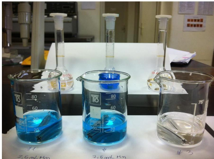
**Slika 10.** Prethodno oblikovane pločice Al/Al<sub>2</sub>O<sub>3</sub> u otopinama za pripremu monolitnih katalizatora.
