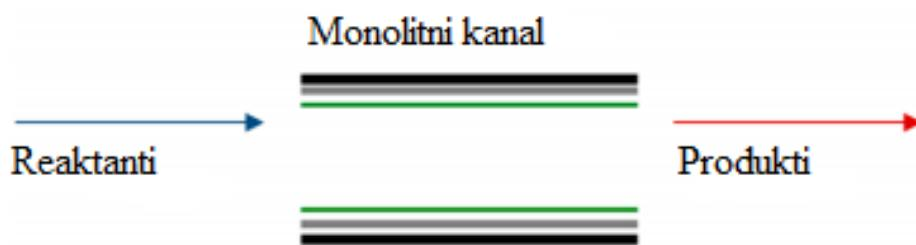
**Slika 8.** Reaktanti prolaze kroz jedan monolitni kanal i izlaze kao produkti. Monolitni zid: crno, sekundarni nosač: sivo, sloj katalizatora: zeleno [36].
