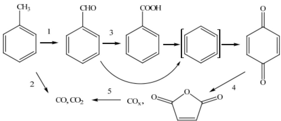
**Slika 3.** Pojednostavljeni prikaz različitih stupnjeva oksidacije toluena.
