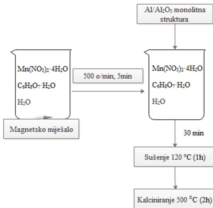
**Slika 9.** Shematski prikaz postupka pripreme monolitnog katalizatora  $\text{MnO}_x$ .
