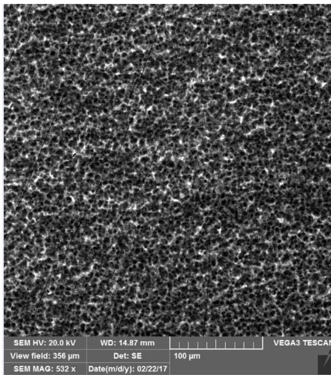
**Slika 14.** Rezultat analize nosača (Al/Al<sub>2</sub>O<sub>3</sub>) katalizatora dobiven primjenom pretražne elektronske mikroskopije (SEM) pri uvećanju od 100 μm.
