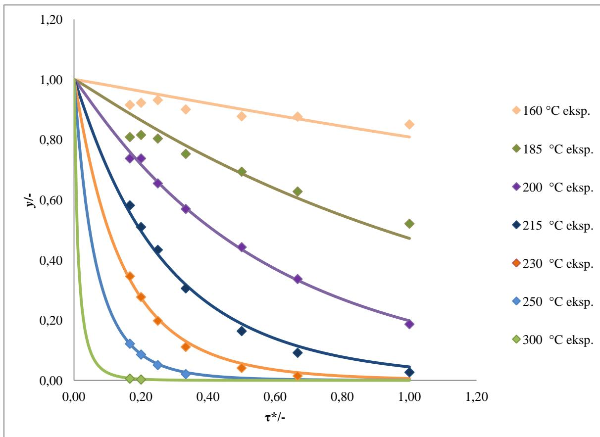
**Slika 22.** Usporedba eksperimentalnih rezultata (točke) s vrijednostima dobivenim prema modelu s međufaznom difuzijom (linije) za različite temperature monolitnog reaktora s  $\text{MnCuO}_x$  (m=0,0040 g).
