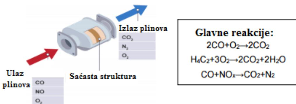
Slika 6. Pojednostavljena shema rada automobilskog katalitičkog pretvornika [34].
