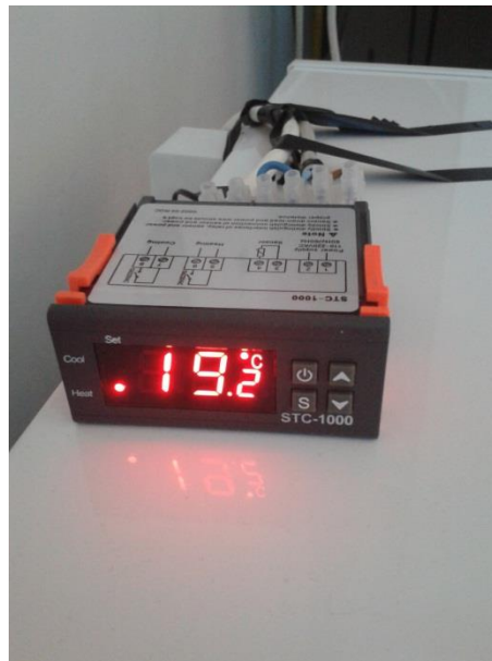
Slika 9. Termostat za regulaciju temperature u škrinji
