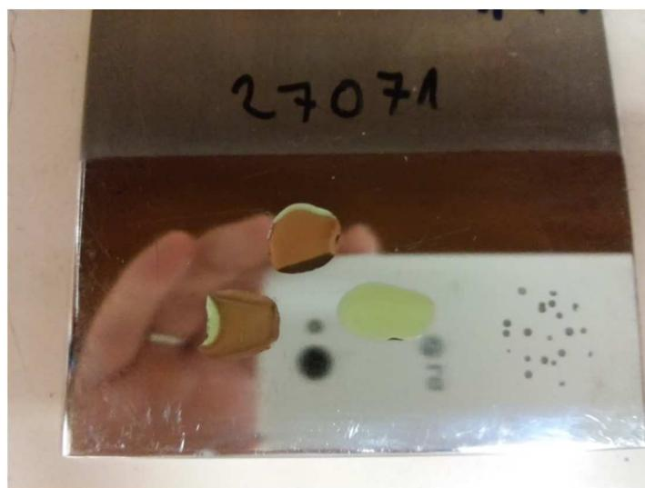
**Slika 5.5.** Uzorak 27071 površinske hrapavosti  $R_a = 0,06 \mu\text{m}$  ( $\Delta R_a = -0,07 \mu\text{m}$ ) i polarizacijskog otpora  $R_p = 5800 \text{ k}\Omega \text{ cm}^2$
