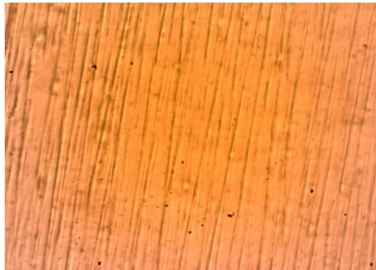
**Slika 4.17.** Prikaz površine metala uzorka tretiranog 15 minuta pri sobnoj temperaturi (povećanje 800x)
