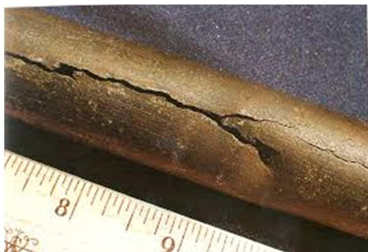
**Slika 2.12.** Primjer koroziskog raspucavanja uz naprezanje
