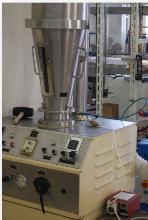
Slika 9. Fotografija granulatora s fluidiziranim slojem Uni-Glatt (Glatt GmbH, Binzen, Savezna Republika Njemačka).
