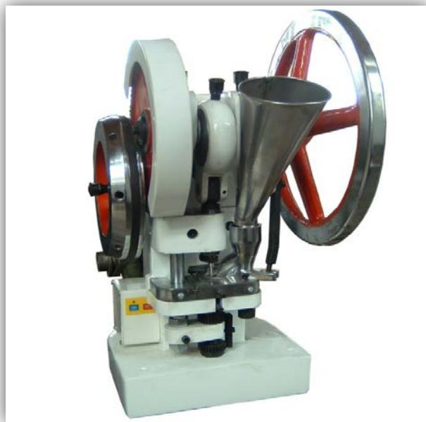
**Slika 10.** Fotografija uređaja za tabletiranje TDP-5T
