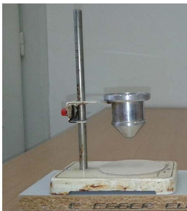
**Slika 13.** Fotografija lijevka za određivanje nasipnog kuta.
