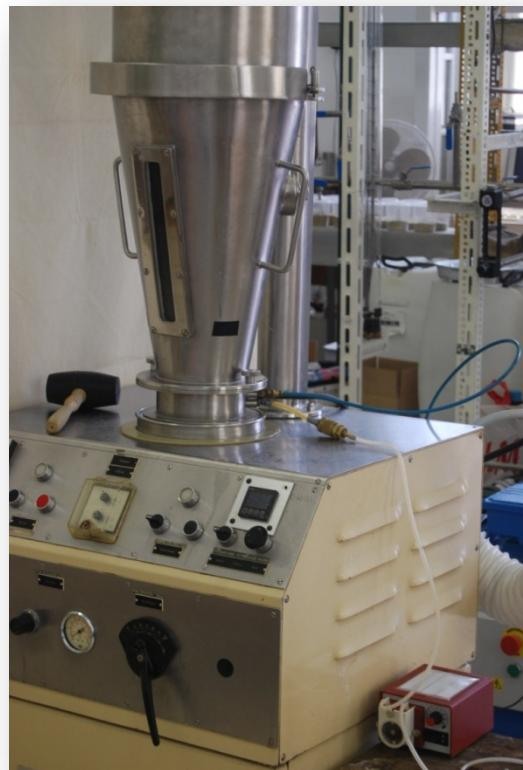
**Slika 9.** Fotografija granulatora s fluidiziranim slojem
