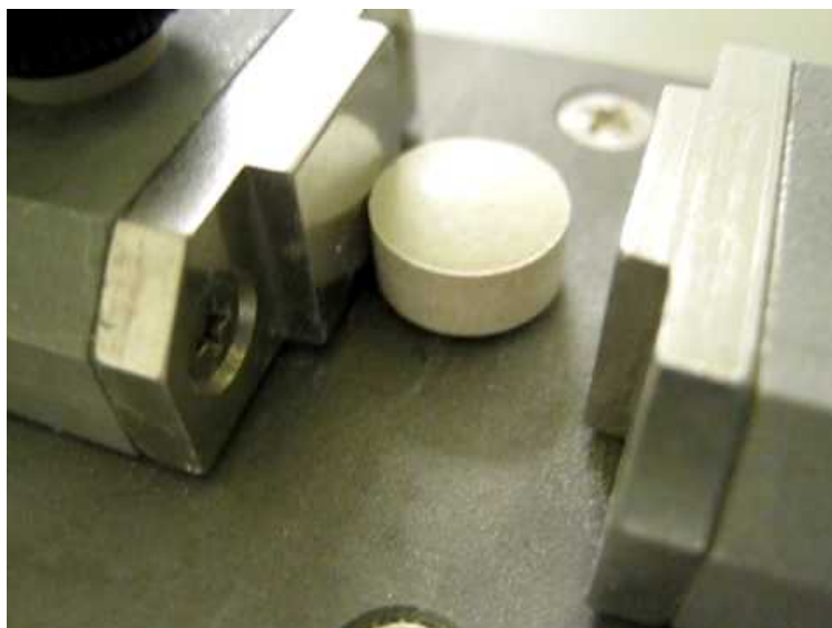
Slika 14. Fotografija uređaja za mjerenje tvrdoće tableta
